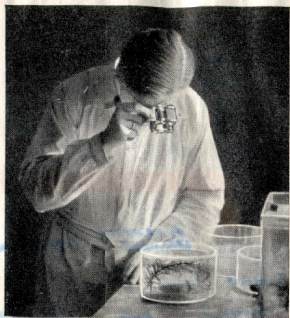
Das Theaterglas TELEATER mit Zusatzlinsen als binokulare Fernrohrlupe
